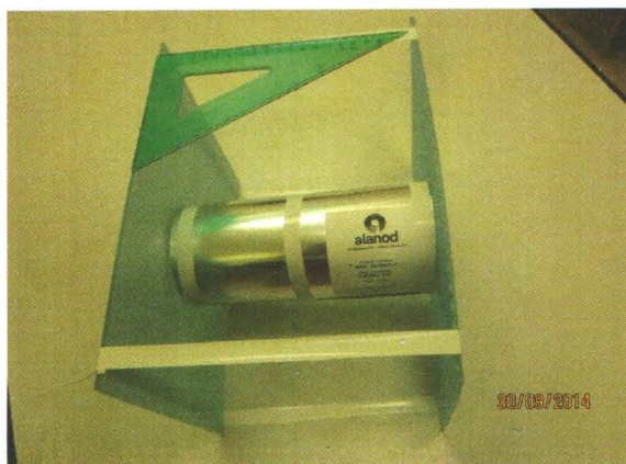
Рис. 3. Фотографии макета системы естественного освещения «SolarWay».
