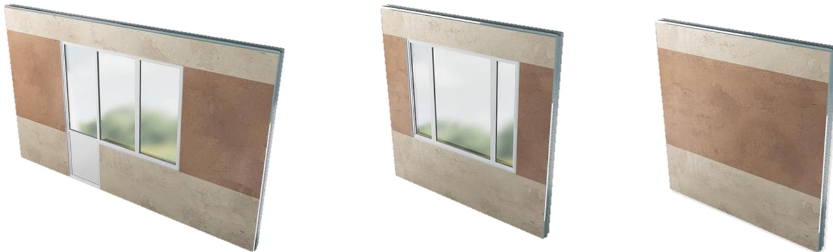
Ограждающая SPANS панель представляет из себя **однослойную**, монолитную стеновую конструкцию из вспененного силиката Техфом, армированного стальным термокаркасом. В состав ограждающих SPANS панелей входят встроенные узлы крепления и регулировки, наружная и внутренняя отделка и установленное остекление. Панели имеют 100% заводскую готовность.
